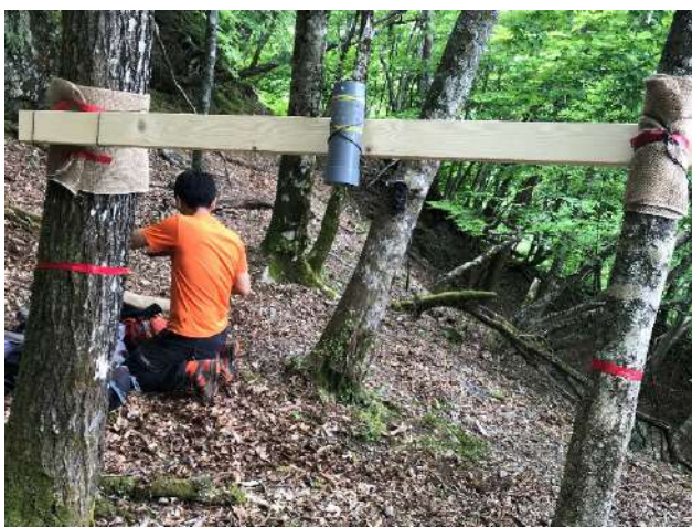
立木を利用して地面と水平に設置した木材の中央部に誘引餌を入れた塩化ビニル管を固定
